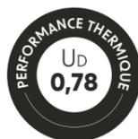
Le coefficient thermique  $U_d$  informe sur la capacité de la porte à isoler des variations thermiques entre l'intérieur et l'extérieur. Plus il est bas, plus la porte est isolante. Les valeurs de ce catalogue sont établies sur la base d'une porte un vantail selon la norme EN 14351-1:2006+AI:2010.
